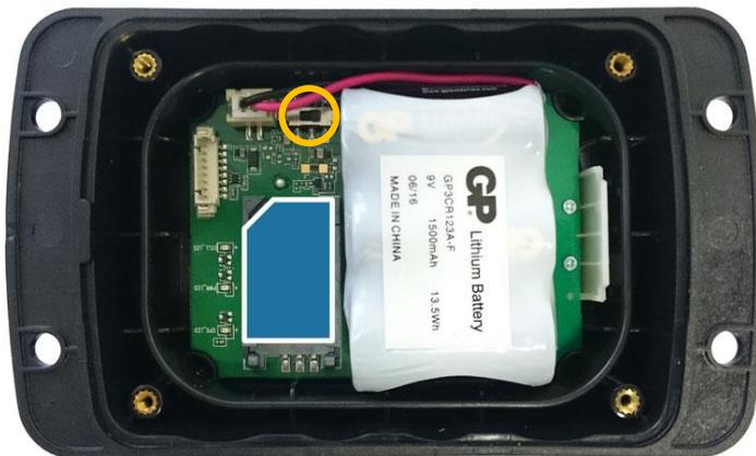
Das Gerät lässt sich mit dem Schalter ein und Ausschalten, siehe gelbe Markierung. Legen Sie abschließend die Abdeckung auf das Gerät und verschrauben Sie das Gehäuse mit den vier Schrauben.
