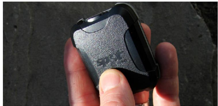
Der Spot Trace ist ein GPS-Tracker, der dank Kommunikation über das Globalstar Satellitennetz nahezu weltweit einsetzbar ist. Im Gegensatz zu vielen anderen GPS-Trackern, die ihre Positionsmeldungen über das GSM-Mobilfunknetz übertragen, funktioniert der Spot Trace unabhängig davon.
