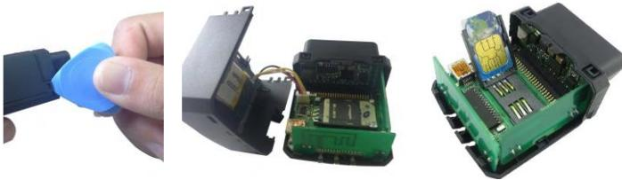
Schieben Sie anschließend die SIM-Karte wie oben abgebildet in die Halterung, klappen Sie die Halterung zu, sodass der Chip der SIM-Karte auf den Kontakten aufliegt, und schieben Sie den oberen Teil der Halterung nach unten (aus der Ansicht wie in der Abbildung). Der obere Teil der Halterung rastet dadurch ein und verschließt die SIM-Karten-Halterung damit sicher.
