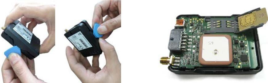
Schieben Sie anschließend die SIM-Karte wie oben abgebildet in die Halterung, klappen Sie die Halterung zu, sodass der Chip der SIM-Karte auf den Kontakten aufliegt, und schieben Sie den oberen Teil der Halterung nach links (aus der Ansicht wie in der Abbildung). Der obere Teil der Halterung rastet dadurch ein und verschließt die SIM-Karten-Halterung damit sicher.
