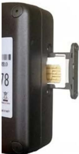
Zum Einlegen der SIM-Karte ist der Einschub auf der linken Seite des GPS-Trackers zu entnehmen. Lösen Sie die Schrauben und ziehen Sie den Einschub heraus.
