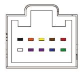
Zum Schalten eines Alarmeingangs wird das Ground-Kabel (schwarz) des Alarm-Kabelstranges mit dem Ground-Ausgang des Stromversorgungsanschlusses (GND) verbunden. Die farbigen Kabel werden analog dazu jeweils per Schaltung mit dem 12V-Ausgang am Anschluss der Stromversorgung (+12VOUT) verbunden.
