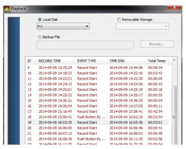
Im diesem Fenster können Sie Videosequenzen zum Abspielen auswählen. Wählen Sie zunächst einen Datenträger ("Local Disc" bzw. "Removable Storage") oder eine gesicherte Datei ("Backup File") aus und doppelklicken Sie anschließend auf einen Eintrag.
